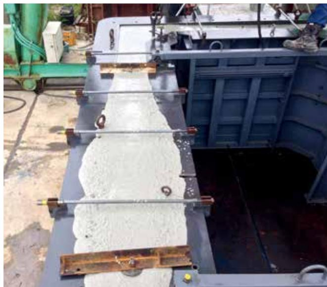
图 1 和图 2 展示的是制造箱型暗渠使用的模具，其容纳混凝土重量达 12.3 吨
